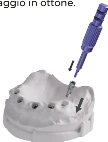
INNESTO E SERRAGGIO DEL MONTATORE NELL'ANALOGO
